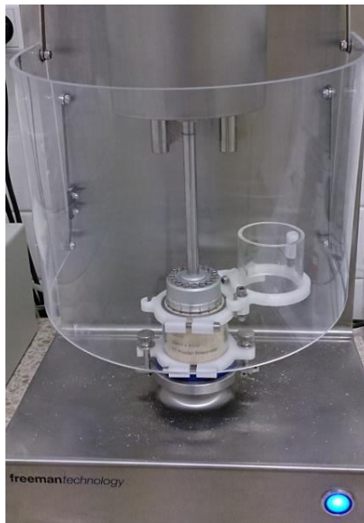
Figure 41. Montage réalisé pour le test de cisaillement
