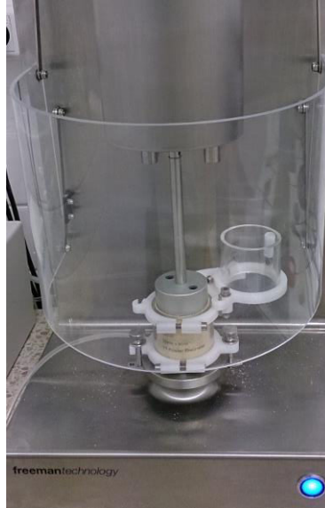
Figure 36. Montage réalisé pour le test de perméabilité
