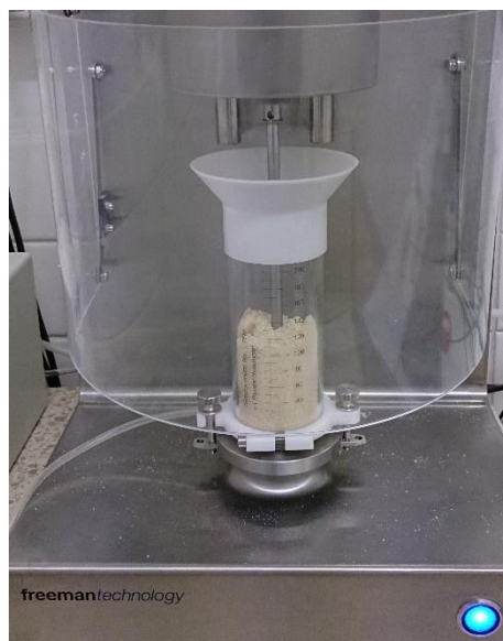
Figure 39. Montage réalisé pour le test d'aération
