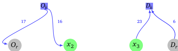
FIGURE 6.8 – Les plus courts chemins exacts sont représentés par des lignes continues de couleur bleu. L'ensemble des chemins calculés sont limités aux lieux potentiels de prise en charge et de dépose.
