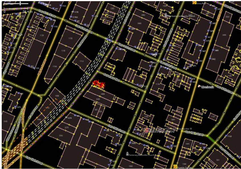
FIGURE 2.2 – Exemple de modélisation d'un réseau routier sous forme d'un graphe (une partie de l'île de Manhattan).
