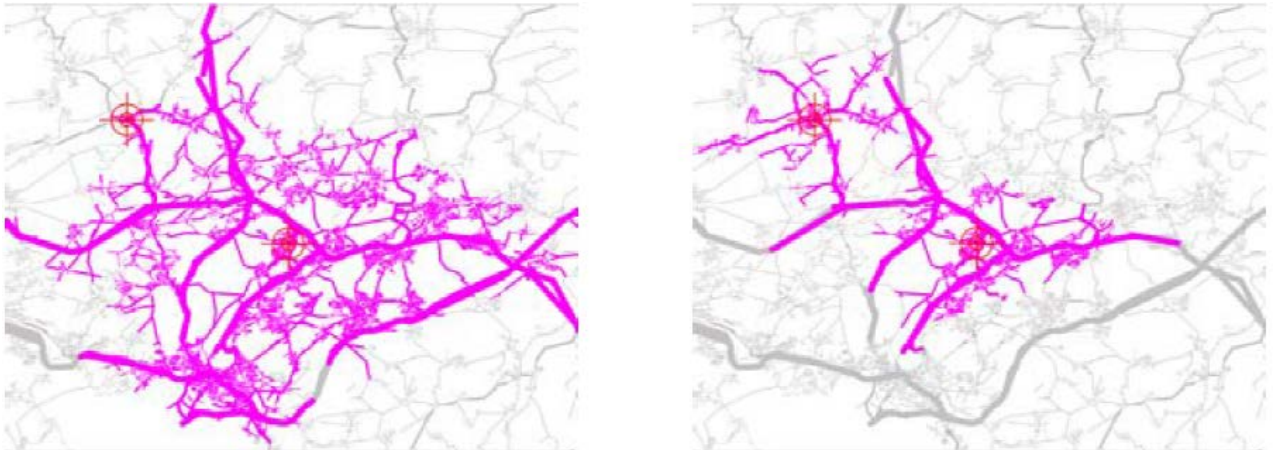
FIGURE 2.3 – L’espace de recherche de l’algorithme de Dijkstra sur un réseau routier entre une source et une destination. A gauche : la version simple de l’algorithme de Dijkstra. A droite : la version bidirectionnelle de Dijkstra.
