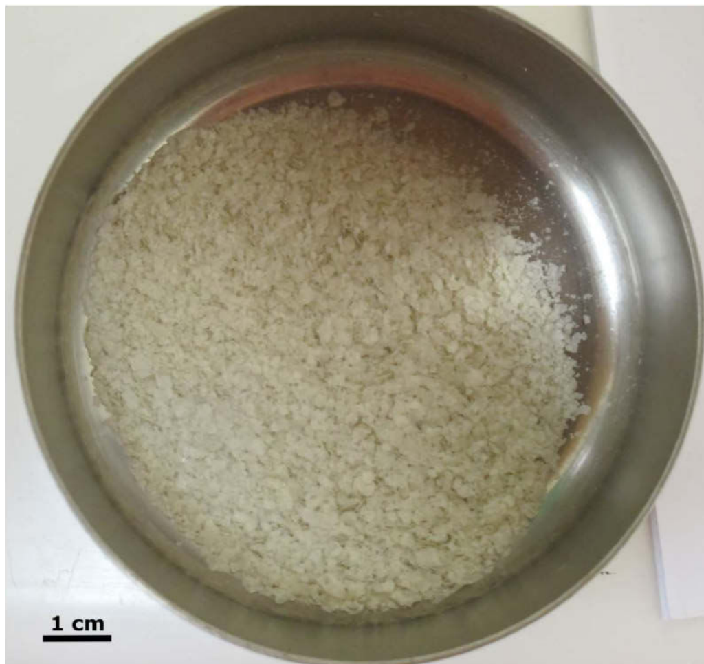
Figure 2.1 Kunipia-G : matériau initial constitué d'amas d'agrégats de taille variable ayant servi à la procédure de caractérisation du matériau.
