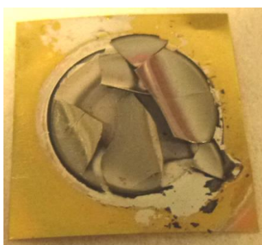
Figure 44 : Rupture d'un film de \text{Bi}_2\text{Te}_3 au cours d'une synthèse
