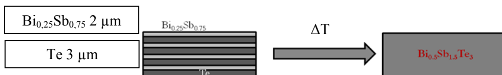
Figure 90 : Schéma explicatif de la synthèse par voie multicouches de faibles épaisseurs
