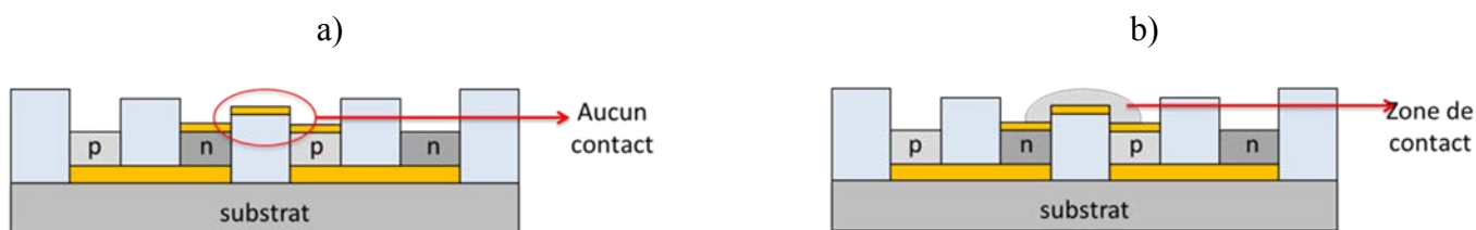
Figure 131 : Schémas détaillant le procédé de mise en contact à la laque d'argent
