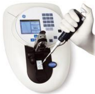
Figure 17 : Photo du NanoVuePlusTM. Cet appareil est un spectrophotomètre permettant de mesurer l'absorbance des 2µL d'échantillons déposés, et d'en mesurer la concentration grâce à la loi de Beer-Lambert.
