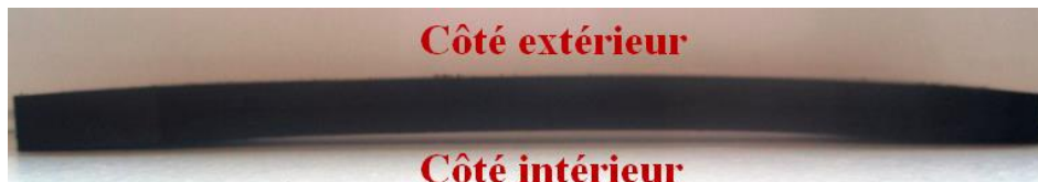
Figure IV.4. Eprouvette prélevée sur un tube PE100
