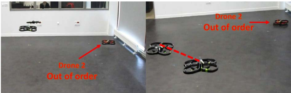
FIGURE 4.22 – Détection d’une défaillance sur un agent de la flotte
