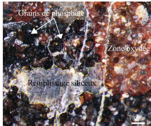
**Figure 6.4 :** Hématisation des grains de phosphate.
