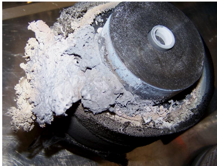
Figure 4.37 : Photographie de la matrice SPS à la suite du frittage FLP430-60-Ø80.
