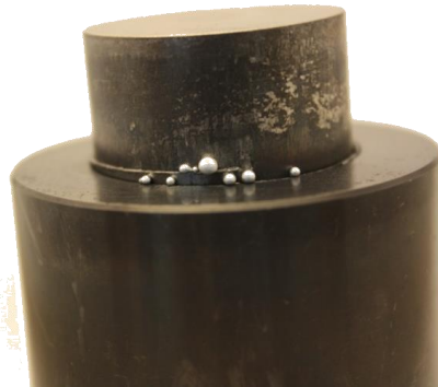
Figure 4.26 : Photographie de la matrice de frittage SPS suite à la montée de 60°C/min à 450°C.
