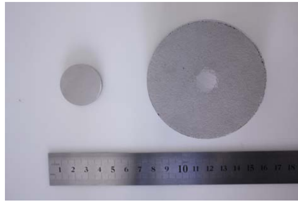
FIGURE II.18 – Photographie des échantillons de l'alliage Al-Zn-Mg issu du lot B consolidé, de diamètres 30 et 80 mm.
