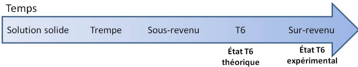
FIGURE III.34 – Comparaison de l'état expérimental observé par rapport à l'état théorique après le traitement thermique de mise en solution, trempe et revenu de l'état T6.
