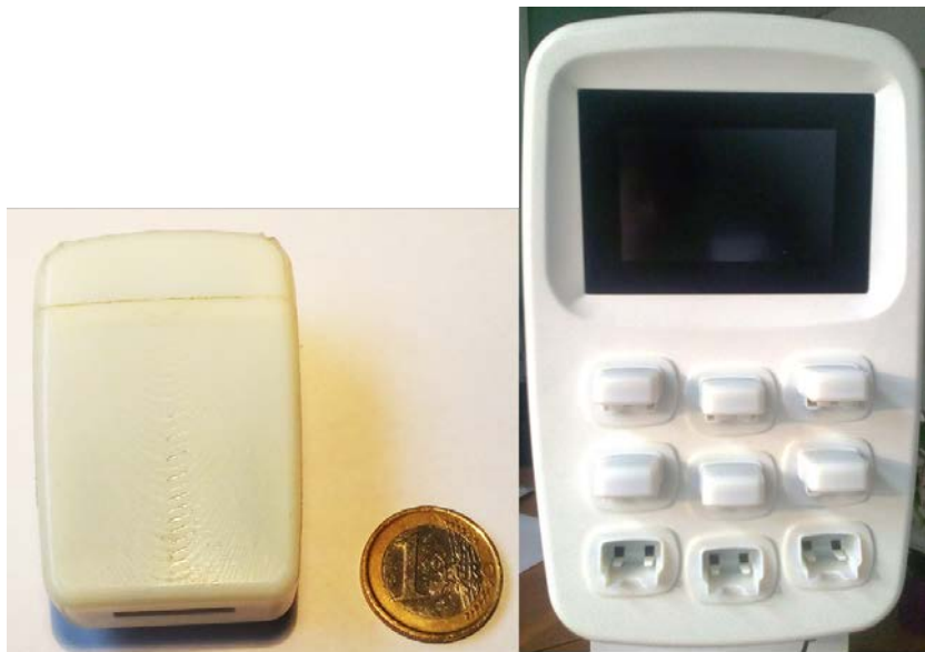
FIGURE 4.22 – Prototype industriel de station d'accueil et de badge.
