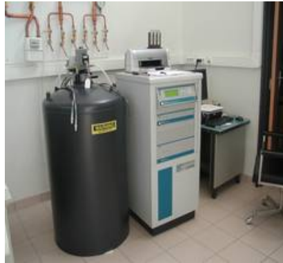
FIGURE 2.16 – Illustration du cryostat PPMS (Quantum Design) utilisé pour la caractérisation du capteur à effet Hall.
