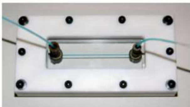
Figure 7 : Photographie du microréacteur en quartz développé par Matsushita et al. [15].
