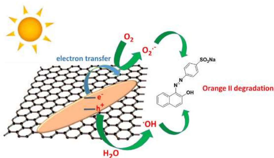
Figure 4 : Illustration schématique du procédé photocatalytique lors d'un dopage avec des matériaux graphitiques (de l'oxyde de graphène réduit) [24].
