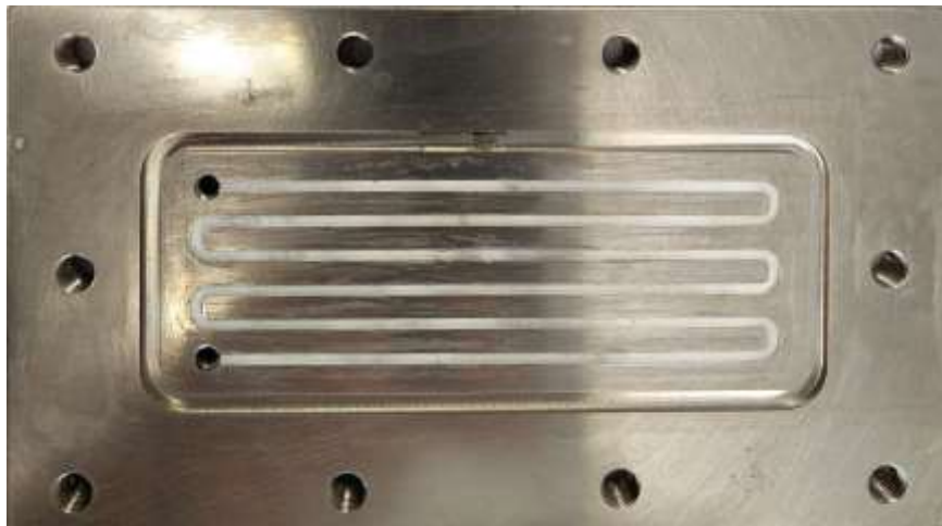
Figure 2 : Photographie du microréacteur monocanal en serpentin avec le dépôt de photocatalyseur.
