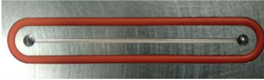
Figure 1 : Photographie du microréacteur monocanal droit ; temps de passage 40 s pour un débit de 5 mL/h.
