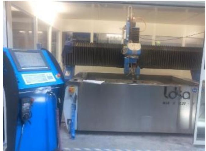
**Figure II.4 :** Machine jet d'eau
