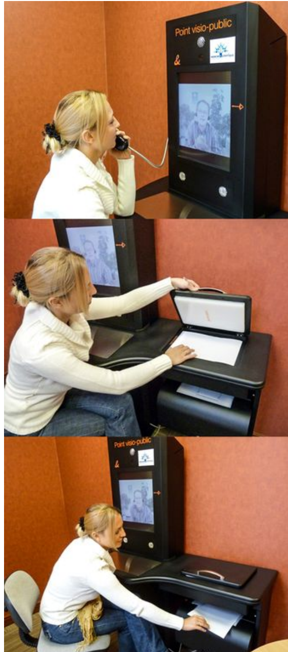
Image 32 – Point visio-public équipé d’une écran tactile, d’une caméra, d’un téléphone, d’un scanner et d’une imprimante 4079
