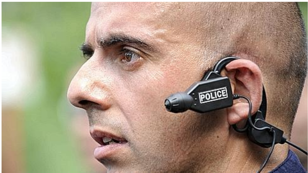
Image 28 – Caméra piéton sous forme d'oreillette. Modèle utilisé dans le passé mais non retenu par le ministère de l'intérieur pour équiper les forces de l'ordre en 2016 4075
