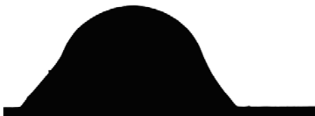
FIG. 6.17.3 - Sn_{95,5}Ag_{3,8}Cu_{0,7} /cuivre sans flux et sous vide à 350°C (à t = t_0 )
