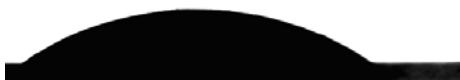
FIG. 6.17.5 - Sn_{95,5}Ag_{3,8}Cu_{0,7} /cuivre sans flux et sous vide à 350°C (à t = t_0 + 2min )
