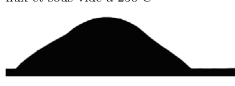
FIG. 6.17.4 - Sn_{95,5}Ag_{3,8}Cu_{0,7} /cuivre sans flux et sous vide à 350°C (à t = t_0 + 1min )
