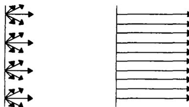
Figure IV- 7 : Section droite d'une source (a) de diffusion (b) injectée par un collimateur.
