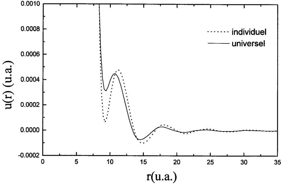
Figure 2.1: Potentiel effectif du Fiolhais pour le Ba au voisinage du point de fusion
