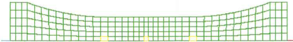
Fig. 16.2 Maillage de l'éprouvette lisse de diamètre 3
