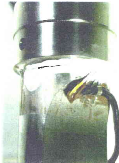
Figure 27 : Montage de la jauge sur l'ailette
