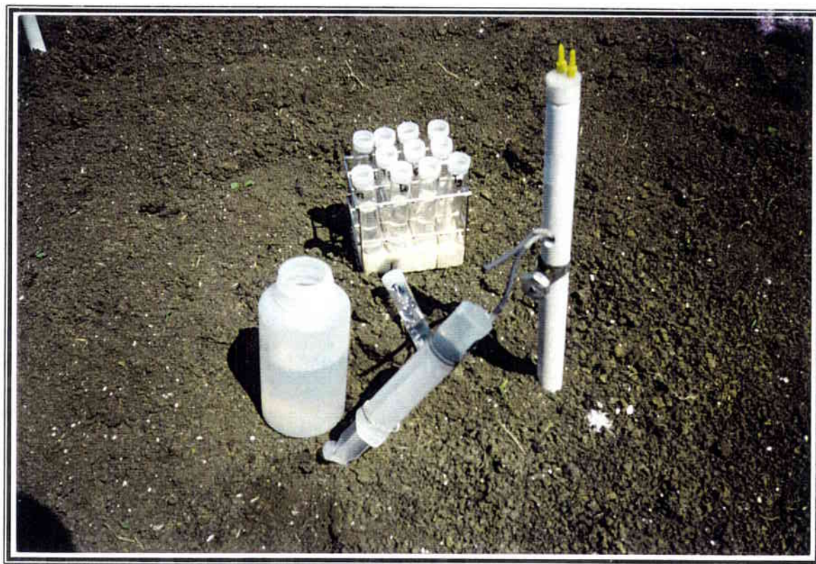
Photo 13 : Dispositif de prélèvement de la solution du sol. Tensionic installé dans la micro-parcelle D retournée en sol nu
