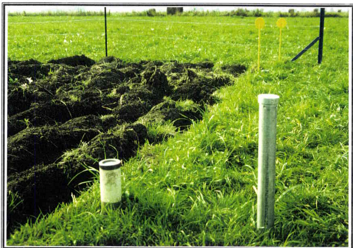
Photo 8 : Piézomètres à 1 et 3 mètres de profondeur à l'entrée d'un carré labouré
