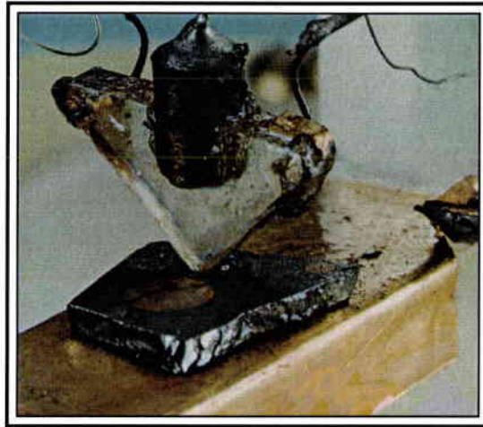
Figure 13 : Premier transistor inventé au Bell Laboratories [81Sze].
