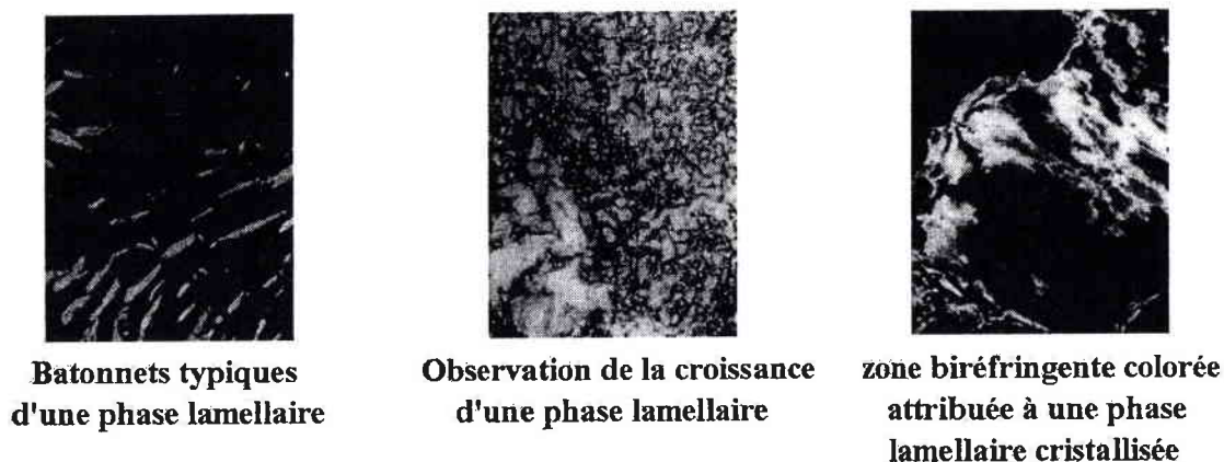
Figure IV-2 : Vues d'un polyacrylate de perfluoroalkyle en microscopie sous lumière polarisée pour différentes organisations semi-cristallines.
