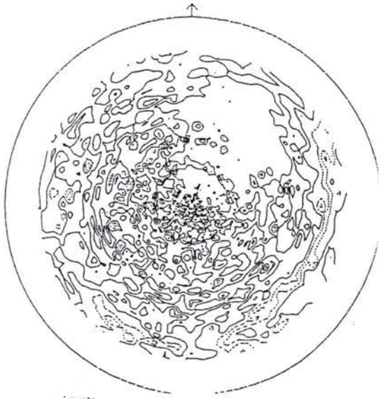
figure57: figure de pôle (017) de \text{Cu}_4\text{Ti}_3 réalisée sur la plaque côté métal de base.
