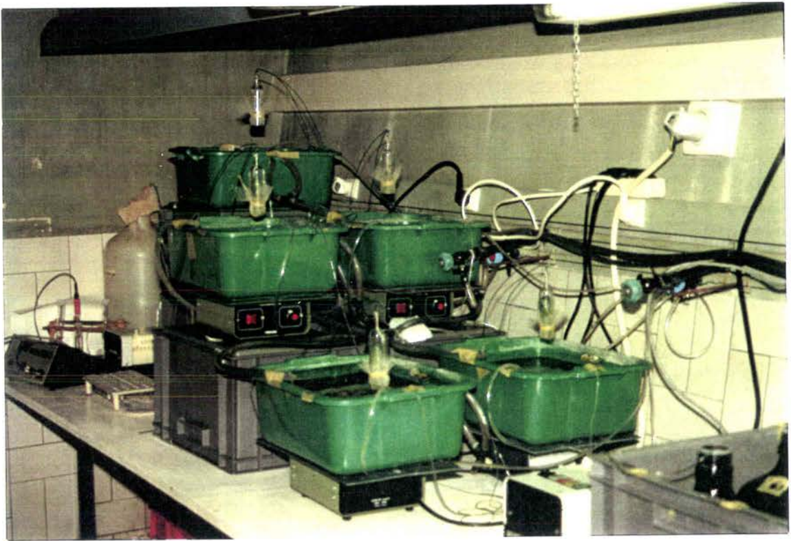
Figure 17. Dispositif expérimental de contamination métallique.
