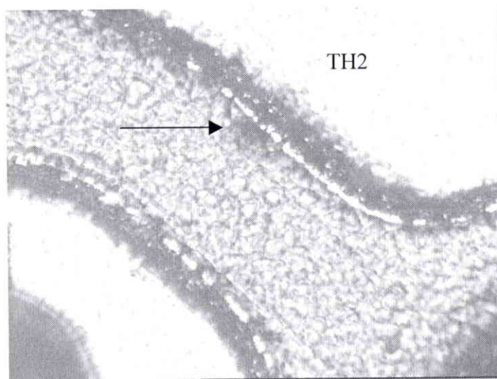
Fig. II-61. Vue optique de la face avant. La métallisation de cathode ne présente pas d'usure particulière. On distingue la fusion surfacique du silicium sous le verre.
