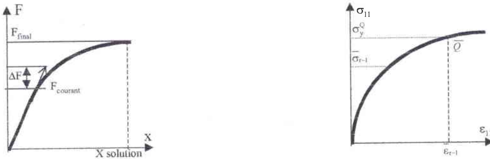
Figure VI.5: schéma monodimensionnel de la résolution incrémentale
