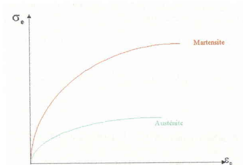
Figure VI.1 écroissage dans la phase austénitique et dans la phase martensitique
