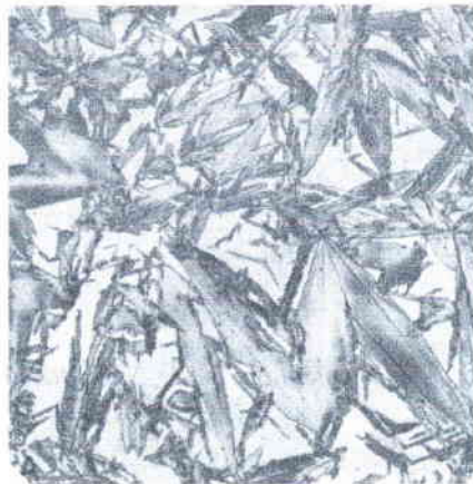
Figure II.7 : martensite athermal obtenue à la température T_q = 150^\circ\text{K} [UL90]
