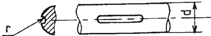
Figure 32 : définition de géométrie d'arbre claveté à bout rond, selon la méthode du gradient.
