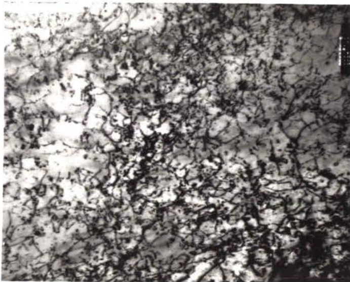
a - (x51 000) – Sous-structure de dislocations semi-homogène, t_m = 30 min
