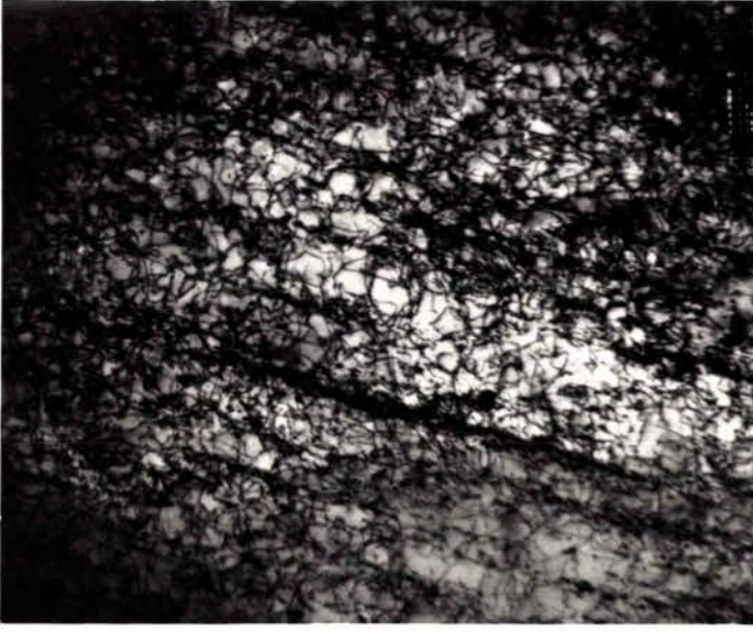
a - (x21 000) – Aspect de la sous-structure de dislocations t_m = 10\ 080 min
