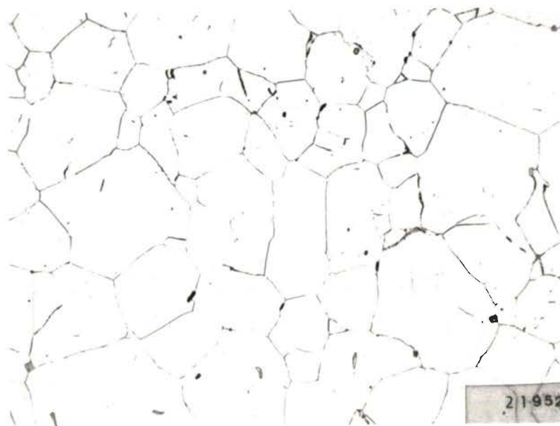
Figure III.1 - x200 – Micrographie à mi-épaisseur sur coupe transversale du plat B108-A en alliage 800 à l'état de grade 1 (état de réception). Attaque électrolytique à l'acide nitrique 20 %.
