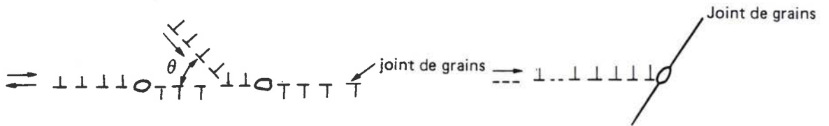
Figure V-34 – Mécanisme de base pour la germination de la décohésion intergranulaire en fluage, d'après B. Quantin (1981) [14].
