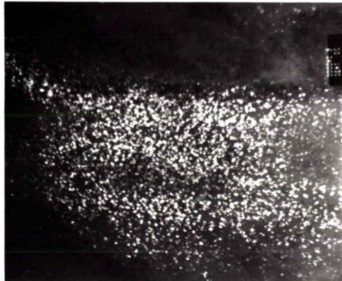
d - (x40 000) – Précipités de type M_{23}C_6 dont la densité dans le grain est relativement homogène, t_m = 300 min
