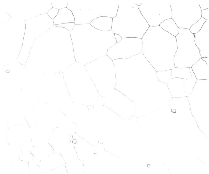
a) x200 - état vieilli : 3000 h à 550°C
