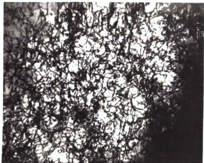
b - (x40 000) – Sous-structure de dislocations homogène t_m = 300 min
