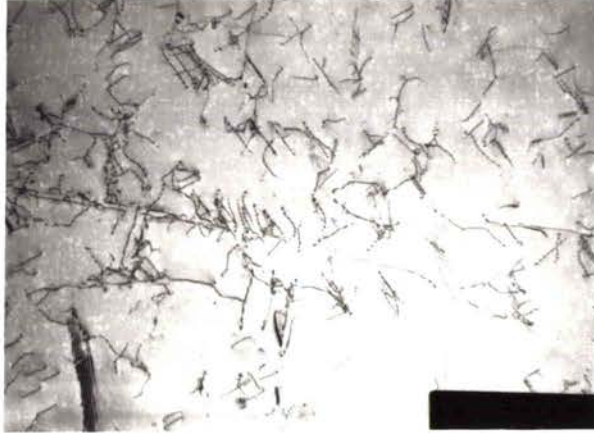
b) x20 000 - Sous-structure de dislocations
