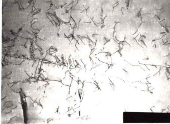
b) x20 000 - Sous-structure de dislocations
