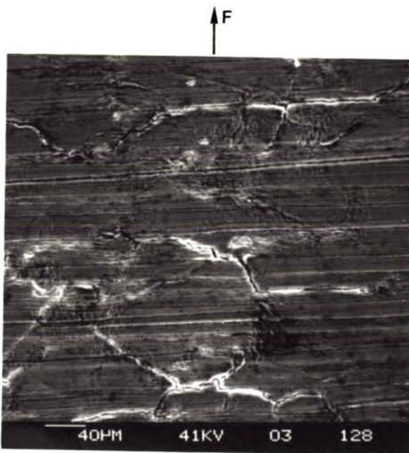
b - Éprouvette N2V17 - Fatigue-relaxation, t_m = 30 min
