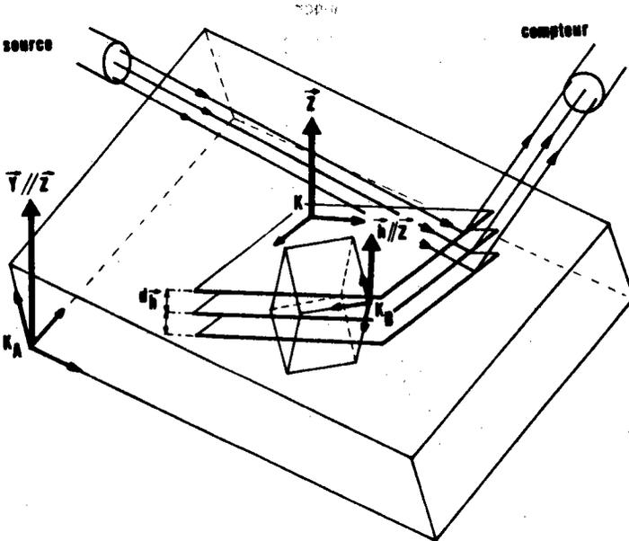
Fig. 5.1. : Les plans cristallographiques  $d_{\bar{h}}$  sélectionnés par l'angle de BRAGG  $\theta_{\bar{h}}$  diffractent lorsque leur normale  $\bar{z}$  est parallèle au vecteur de diffraction.
