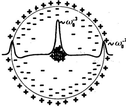
Fig. 6.1. : Représentation schématique de la décomposition de la partie paire d'une orientation idéale, centrée en l'origine, ou texture cube sur face;  $\omega_0$  ( $= 1/5$  rd dans la figure) fixe la largeur à mi-hauteur de la distribution gaussienne. La charge positive n'est restituée que pour moitié en l'origine ( $1/2 \delta_1$ ), flanquée d'une charge positive fantôme distribuée sur la surface- $\Pi$ .
