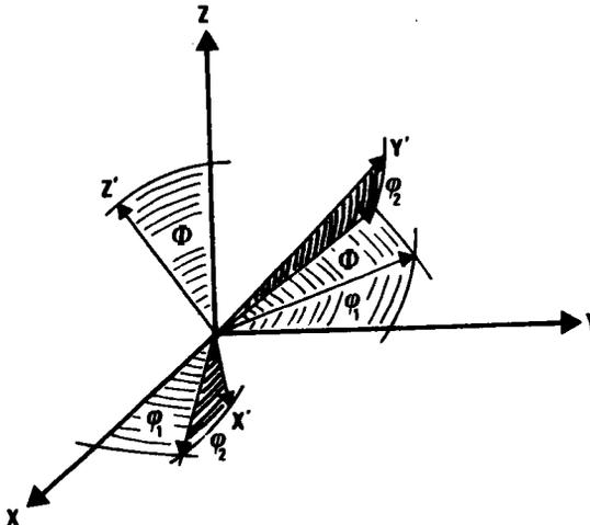
Fig. I.2. : Description des angles d'EULER  $\{\varphi_1, \phi, \varphi_2\}$  dans la convention du repère mobile (d'après H.J. BUNGE /1/).
