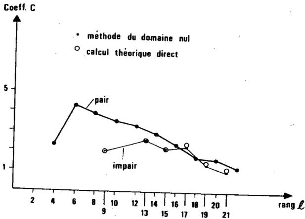
Fig. 8.3. : Fonction de texture théorique gaussienne : valeurs moyennes des coefficients  $C$  pairs et impairs. Coefficients impairs obtenus par :
