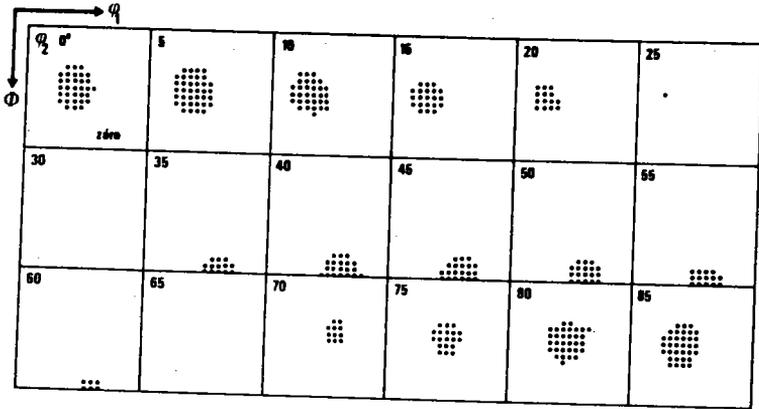
Fig. 8.2. : Domaine nul  $Z^0$  dans l'espace des orientations  $G$ , déterminé à partir des domaines nuls  $Z_h^0$  des figures de pôles correspondant à la gaussienne Fig. 8.1. (Les points marquent les orientations présentes. Le domaine nul est, au contraire, vide de "points d'orientation").
