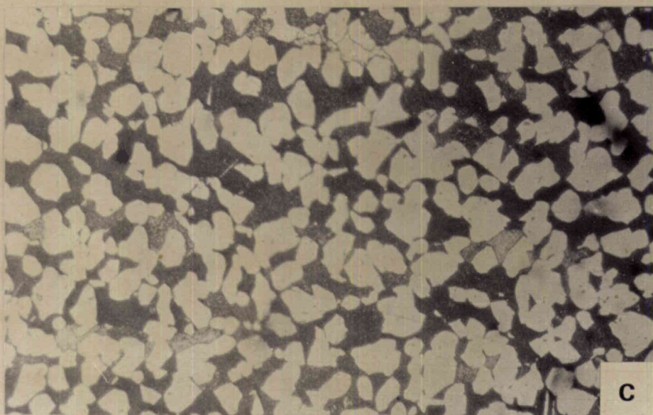
Fig. III. 3 Laiton de soudobrasure - Coupe longitudinale
