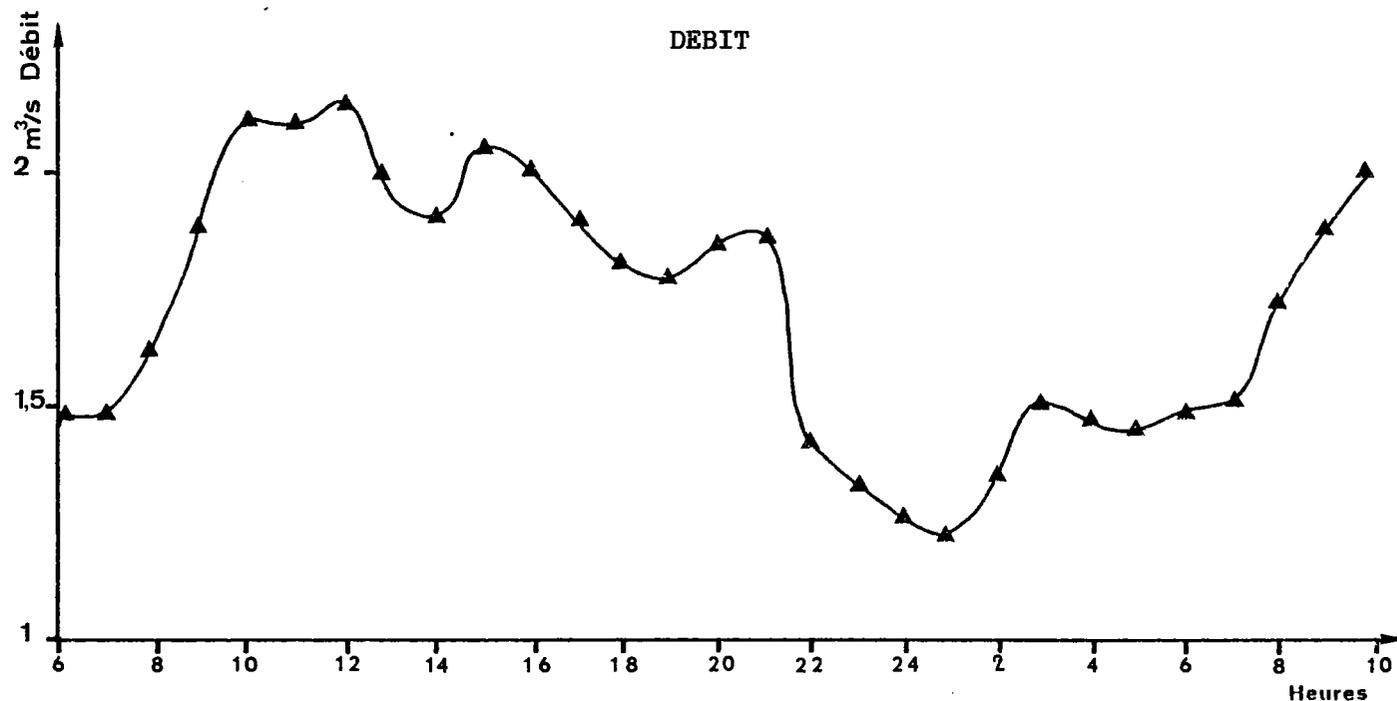
**FIGURE 8** : Débits d'eaux usées traitées enregistrés dans le chenal de rejet de la station d'épuration de 6 h le 23.04.1980 à 10 h le 24.04.1980.
