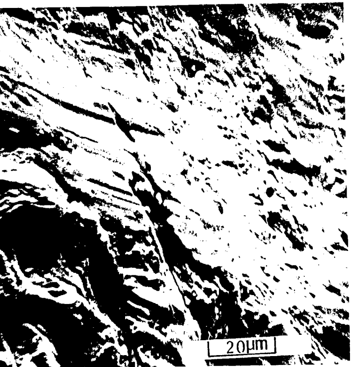
a. aspect d'une zone matée de la préfissure
