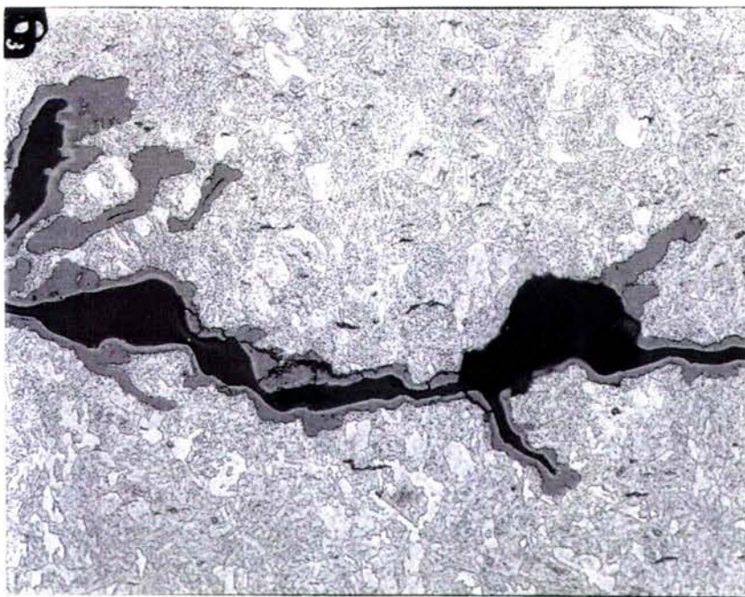
PHOTO 7 : Détail de photo 6 Fissure oxydée
