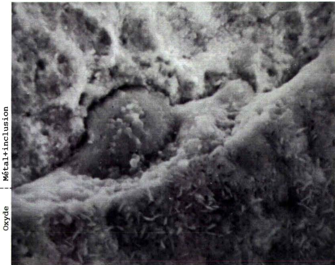
PHOTO 11 : Microfissure sur inclusion
