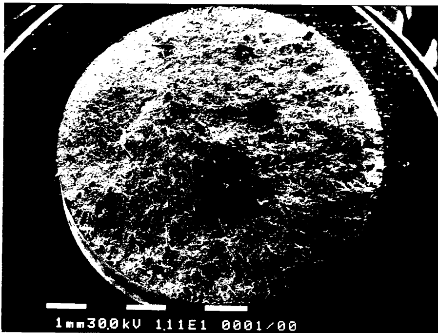
PHOTO. 20: ESSAI à 800 MPa. THERMOMECANIQUE FACIES de RUPTURE
