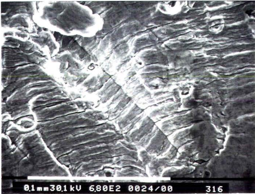
PHOTO. 18: STRIES de FATIGUE (ESSAI à 500°C)
