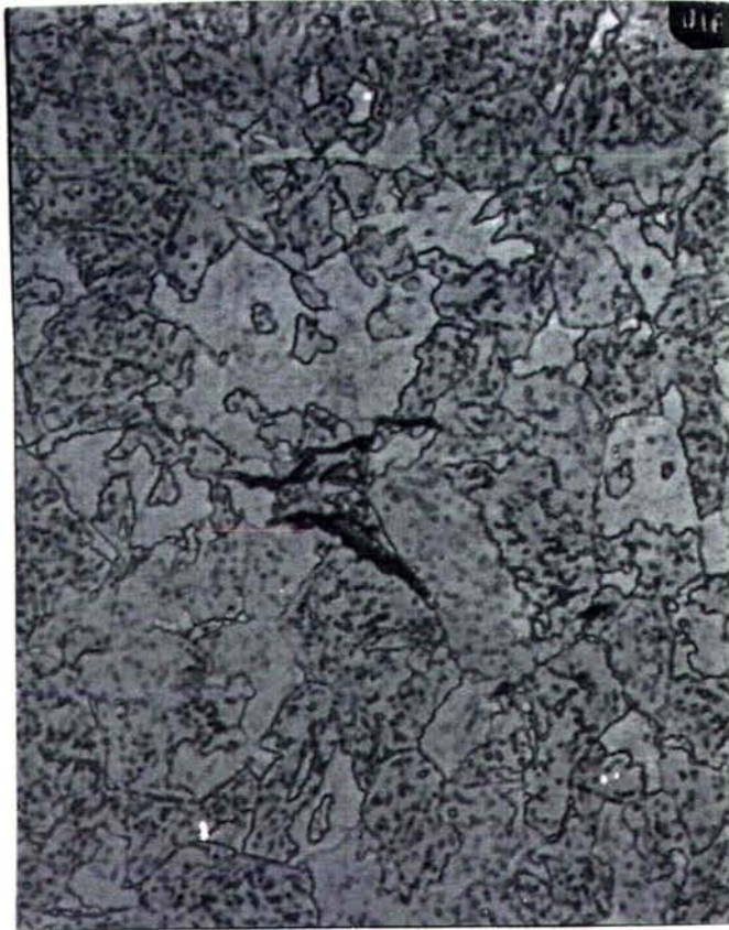
PHOTO 8: Détail de photo 7 Microfissure sur inclusion
