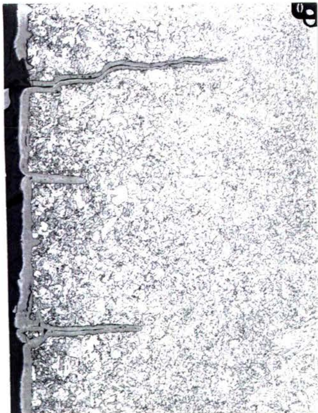
PHOTO 9: Fissures sur éprouvette testée suivant le cycle "Alsthom Interne" Coupe en long à mi-épaisseur
