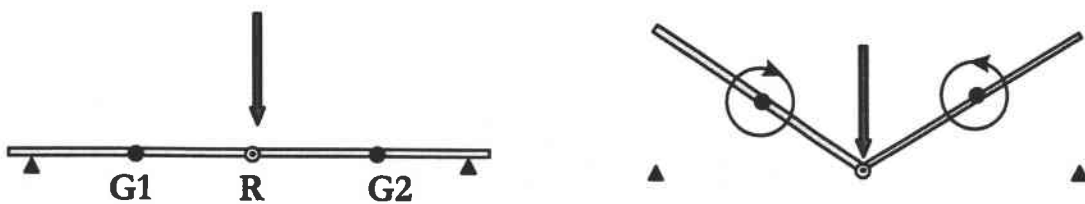
Figure 5-39 : Perte de contact aux appuis.
