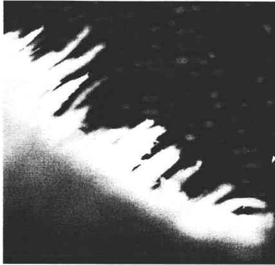
photo 5-16 : Faciès de rupture d'une éprouvette sollicitée en flexion trois points quasi-statique.
