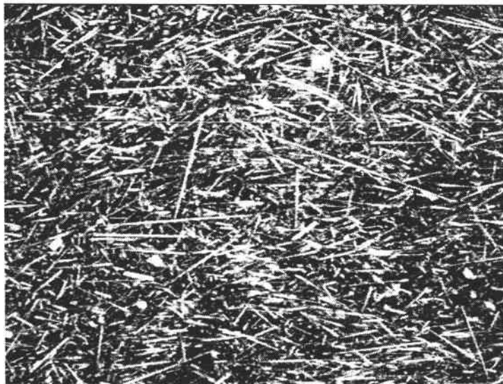
Figure III.C.2 : Observation au microscope optique du mélange ARC-40/32 chargé à 20% de fibres de carbone T300-mld après un traitement de 6 minutes aux ultrasons
