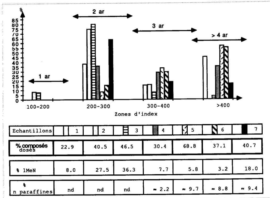
**Figure 28.** Répartition des fractions "Huiles" (HS) en classes de composés en fonction des zones d'index.
