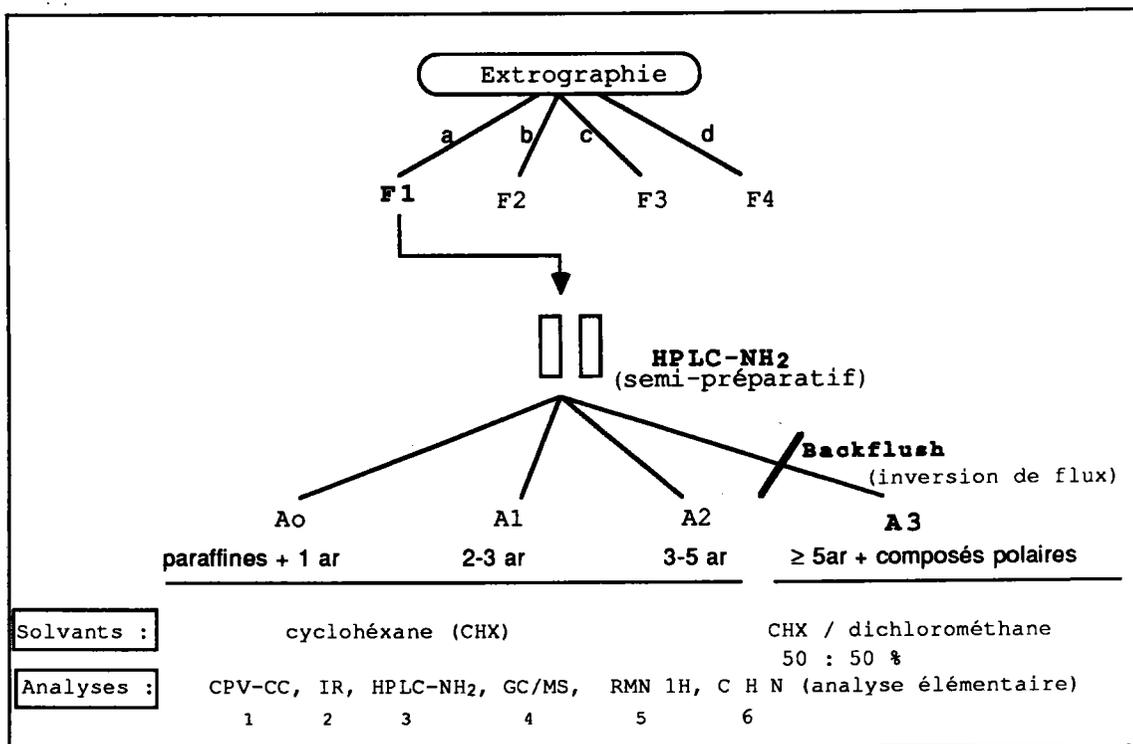
**Figure 34.** Organigramme de la séparation des fractions F1 d'extrographie par HPLC sur Lichrosorb NH<sub>2</sub> au stade semi-préparatif. a, b, c, d: série éluotrope de l'extrographie. ar : noyau aromatique. Deux colonnes : L = 40cm (25-40µm)
