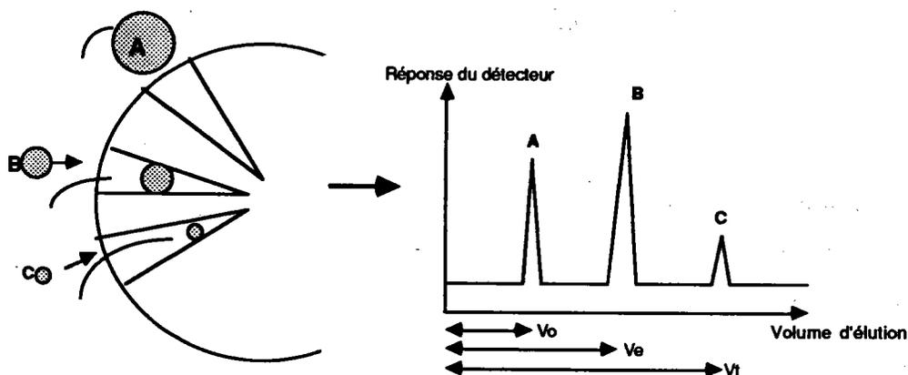
Figure 12. Schéma de principe de la GPC.
