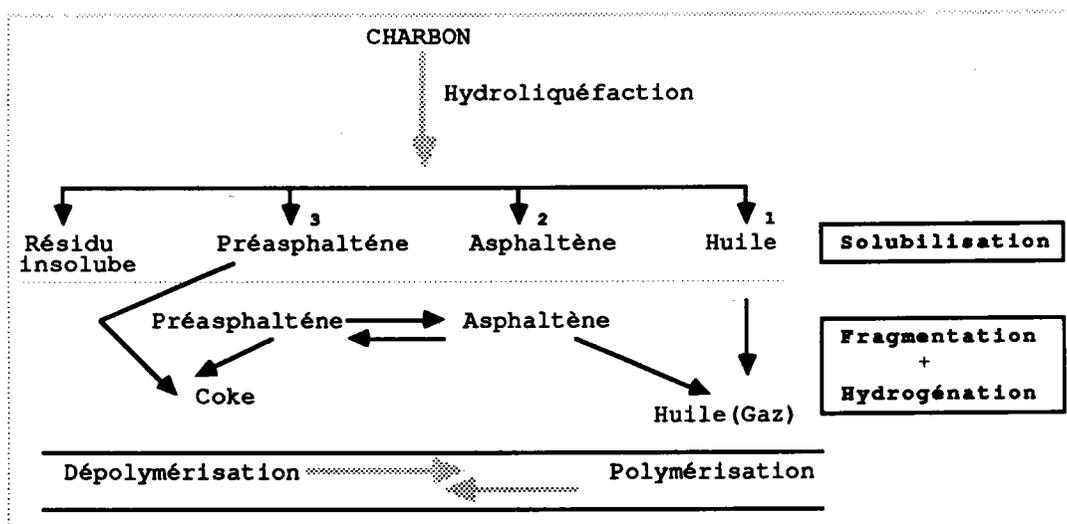
**Figure 6.** Hydroliquéfaction du charbon (selon 16). (1) hexane soluble. (2) hexane insoluble, toluène soluble. (3) toluène insoluble, tétrahydrofurane soluble.
