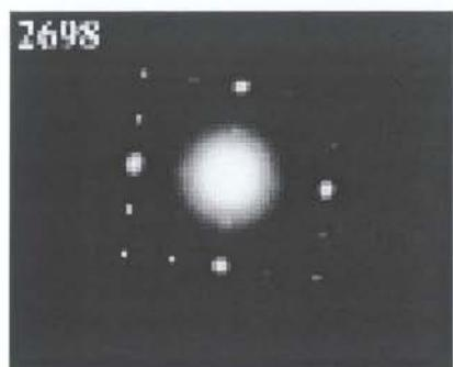
Figures III.5: Clichés de diffraction électronique de la Na-magadiite, parallèles au plan [001].
