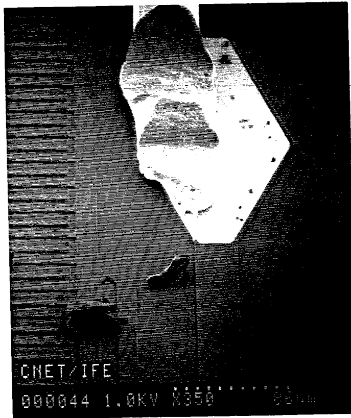
Photographie 5.5: Fil décentré sur sa prise de contact (MEB)
