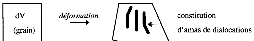
Figure C.1.3 : hétérogénéisation d'une zone d'un grain.
