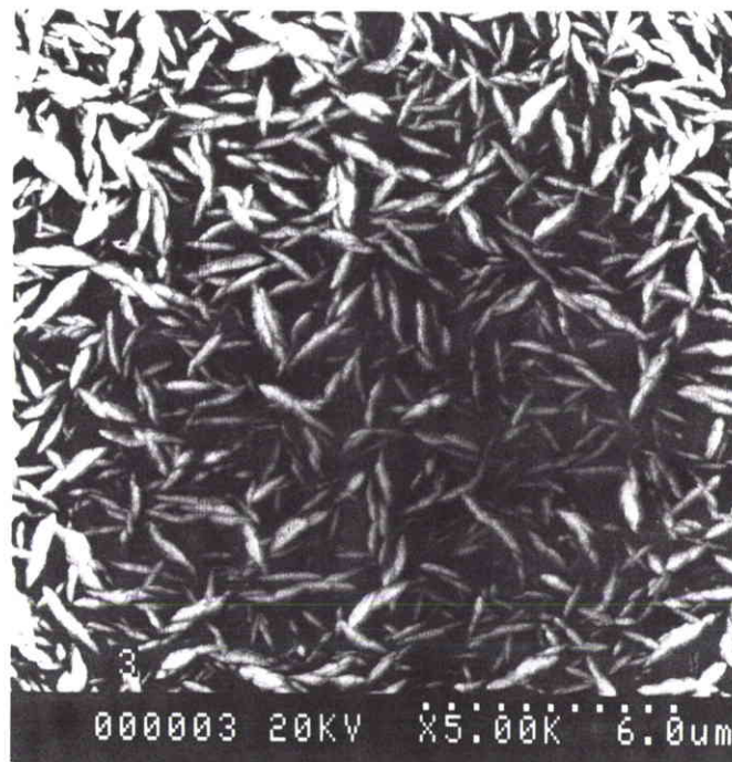
Photo 4 : dépôt sur inox, face au contact de l'électrolyte
