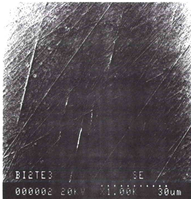
Photo 2 : dépôt sur inox, face au contact de l'électrode
