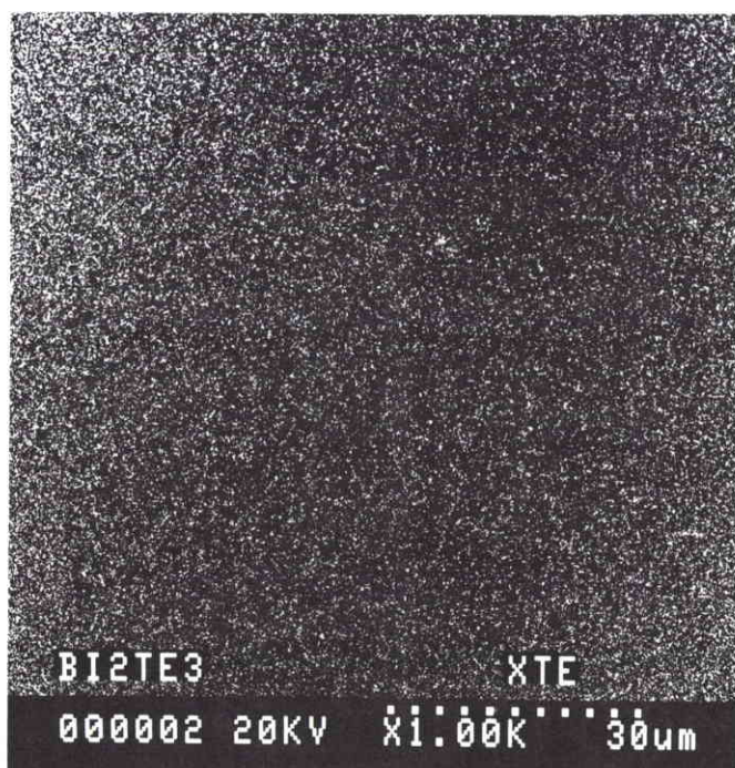
Photo 5 : Image X en tellure, dépôt sur inox, face au contact de l'électrolyte
