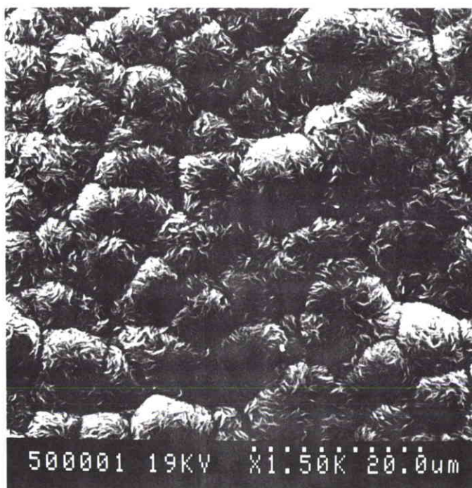
Photo 6 : dépôt sur aluminium, face au contact de l'électrolyte
