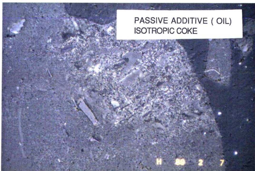
Figure. 1. 24. Photographies donnant l'effet d'un additif actif et d'un additif passif en pourcentage de poids d'additifs sur le charbon de Merlebach
